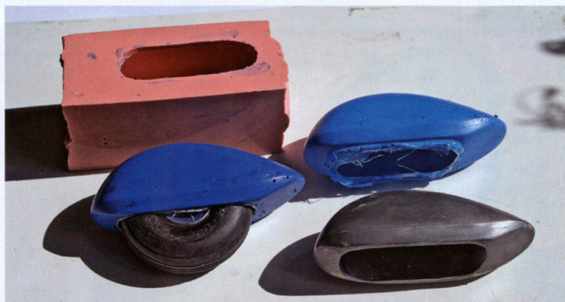
◀ Es lebe das gießfähige Silikon! Das Balsa-Autospachtel-Urmodell der Radverkleidung in einen Pappkasten eingehängt und einfach umgossen. Die einlaminierten GFK-Radverkleidungen flutschen dann aus der Form wie nichts. ▲
