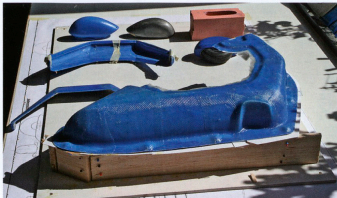
Kulissenbau aus Balsaholz, Kunststoff und etwas Schulknete. Alles ist sorgfältig mit Trennmitteln (Grundierwachs + Folien-PVA) behandelt. Die linke Rumpfhälfte ist fertig einlaminiert. – Umdrehen, Kulisse abbauen, beide Trennmittel aufbringen und die zweite Hälfte laminieren.
