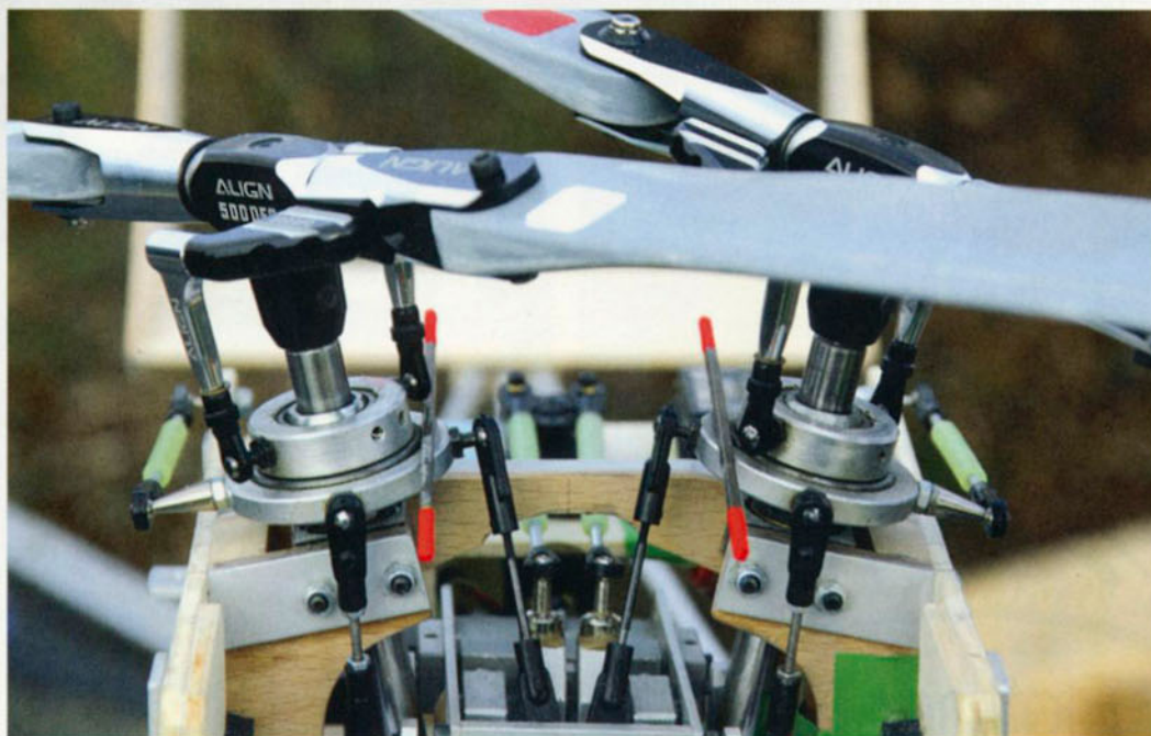
Zwei Vierkant-Schweißdrähte als Einstell-Lehren für die Nick-Parallel-Kontrolle sowie die X-Roll-Einstellungen der beiden Taumelscheiben. Und alles bitte ganz exakt im rechten Winkel zu den Rotorwellen!
