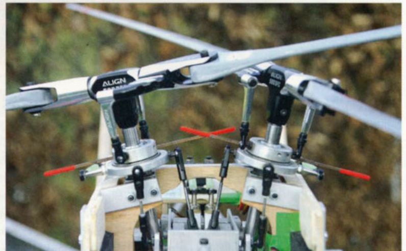
Zwei Vierkant-Schweißdrähte als Einstell-Lehren für die Nick-Parallel-Kontrolle sowie die X-Roll-Einstellungen der beiden Taumelscheiben. Und alles bitte ganz exakt im rechten Winkel zu den Rotorwellen!
