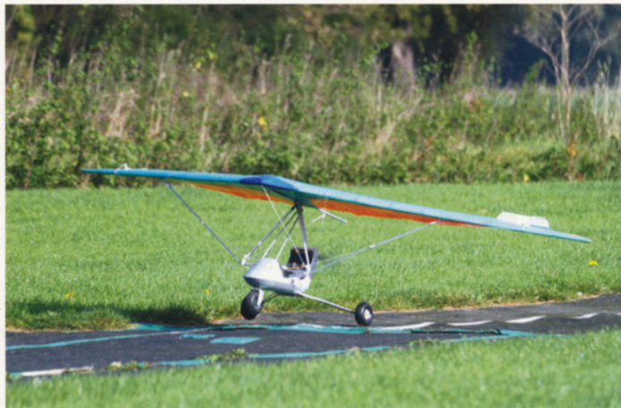
Start von der Gummistartbahn des FMC Condor Bückebug: Vollgas, ziehen und erst einmal auf Höhe gehen! Hier ist auch die aufgerichtete Störklappe auf dem Flügel gut erkennbar.
