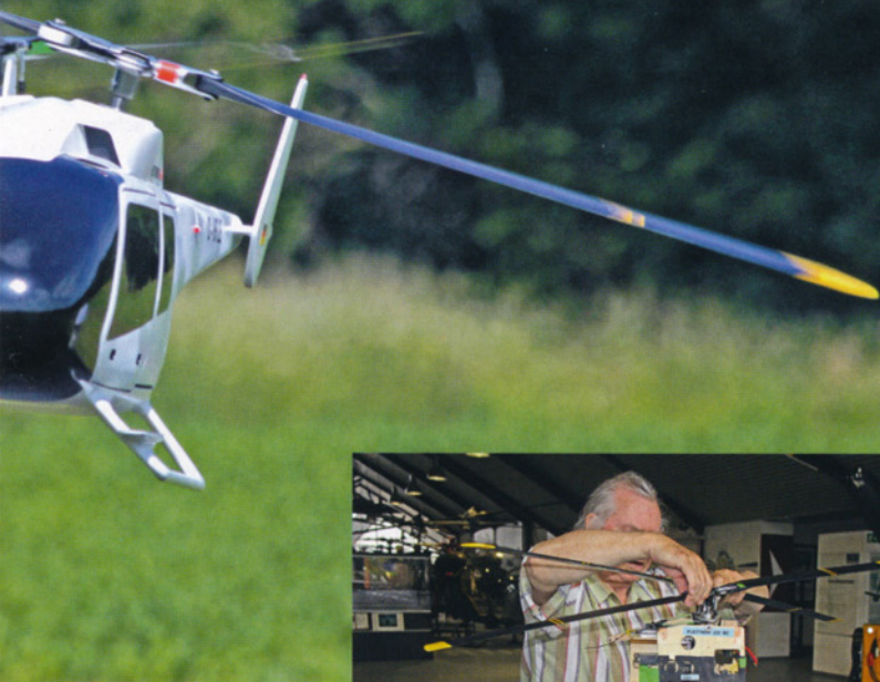
Der Mechanikblock wird von der Hand des Autors in die Zelle eingefädelt und im Schwerpunkt verschraubt.
