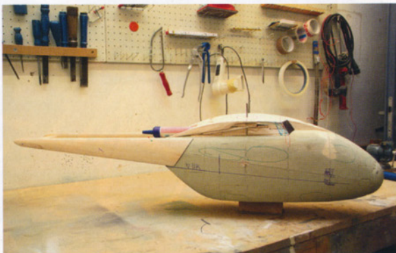
Der Rohling wartet aufs Spachteln, den Feinschliff, weitere Lagen Spritzspachtel, Feinschliff, Spritzspachtel, Feinschliff...!
