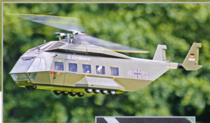
Der Flettner NH-222 (Bericht in ROTOR 6, 7, 8/2014) im Maßstab 1:18 basiert aus der Umwandlung einer CH-53G in einen Stealth-Hubschrauber mit ineinanderkämmernden Rotoren.
