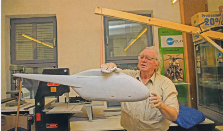
Die Negativ-Formteile der Zelle des Flettner 107 sind fertig, und die Positiv-Teile fast unbeschädigt »herausgehüpft«. Jetzt steht das Laminieren der beiden Rumpfhälften an.
