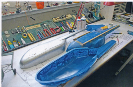
Die Negativ-Formteile der Zelle des Flettner 107 sind fertig, und die Positiv-Teile fast unbeschädigt »herausgehüpft«. Jetzt steht das Laminieren der beiden Rumpfhälften an.
