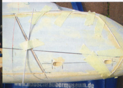
Der Rohling wartet aufs Spachteln, den Feinschliff, weitere Lagen Spritzspachtel, Feinschliff, Spritzspachtel, Feinschliff...!
