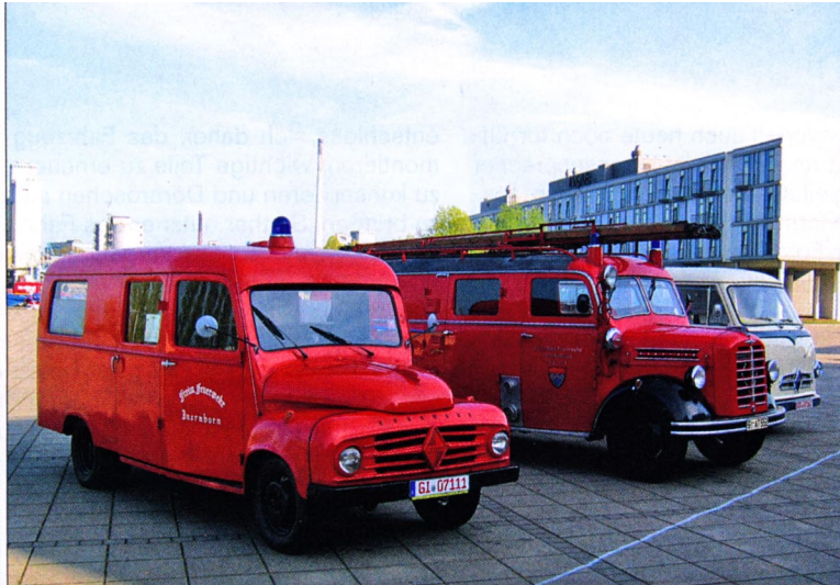
Umbau: Aus dem ehemaligen Krankenwagen auf B 1500 wurde ein TSF. Dahinter ein LF 8 Metz auf B 2000D.
