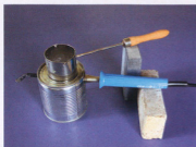
So funktioniert die Weißmetall-Gießerei des Autors: Bleichlöse mit drei Ausschnitten, eingesteckter LötKolben, zwei Schließklötze, Schmelzpot.
