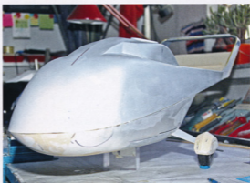
Schnell entsteht die neue Form der Zelle auf Basis des ersten Ur-Rumpfs vom Flettner 107 Pampa. Mit neuen Konturen aus Messingrohren, die damit als »unkaputtbare« Schleif-Schablonen die beabsichtigten »Bügel« bilden.
