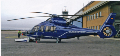
Aber warum einfach, wenn's auch recht schön kompliziert geht? Eine EC 155 (jetzt H155) der Bundespolizei ist auf ihren drei – etwas klein geratenen – Rädern gelandet. Ein Mechaniker schiebt nun per Fernsteuerung die Spezial-Transport-Plattform unter das Bugrad und die Maschine rollt elektrisch geschoben – falls die Akkus der Plattform vollgeladen sind – in den Hangar.
