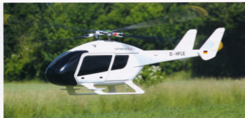
Die Vorgängerversion des Flettner 207 FAKT: Der Flettner 107 Panda mit 2x 1.220 mm Rotordurchmesser. Die Hauptrotorblätter sind Marke Eigenbau, die Rotorköpfe stammen vom T-Rex 500 DFC.
