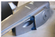
Mit Feigensiber gespritzt – das blitzschnell trocknet und nachgeschliffen werden kann. Nach dem Trocknen wird das Ur-Modell an der – nur gehefteten – Mittelinie zerteilt und zur Abnahme der Negativ-Formen auf eine beschichtete Spanplatte geklebt.
