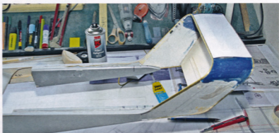
Schnell entsteht die neue Form der Zelle auf Basis des ersten Ur-Rumpfs vom Flettner 107 Pampa. Mit neuen Konturen aus Messingrohren, die damit als »unkaputtbare« Schleif-Schablonen die beabsichtigten »Bügel« bilden.
