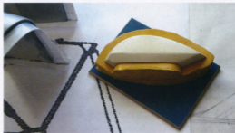
Die Radverkleidung ist zur Hälfte in Knete eingepackt, um nun die erste Negativform aus GFK zu laminieren. Dann die Knete entfernen und die zweite Hälfte dagegen setzen.
