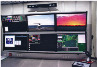
Der Arbeitsplatz für die Flugingenieurerei im FlexMobGCS (flexible mobile Bodenkontrolle) von ESG.
