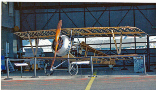
Die im Bau befindliche Replika einer Nieuport Nie.XXII C1 der Memorial Flyers aus Neuendorf (Solothurn)
